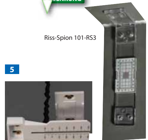
oben: Rissmonitor 101-TT4 vor der Messung unten: Rissmonitor 101-TT4 bei der Messung
