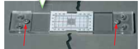
Riss-Spion 101-RS1P - Die roten Pfeile zeigen die Metallplättchen zum Messen mit dem Messschieber
