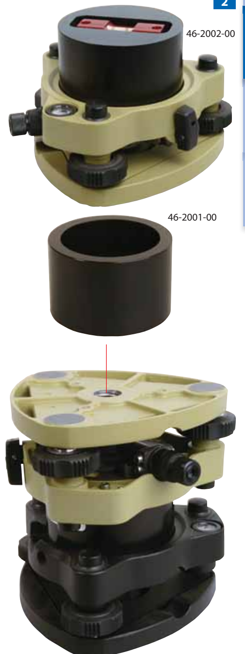
Schematischer Aufbau zur Justierung eines Dreifuß-Lotes mit 46-2001-00 oder 46-2002-00
