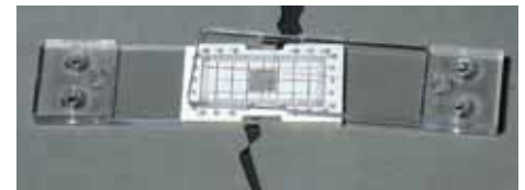
Riss-Spion 101-RS1 nach Verformung
