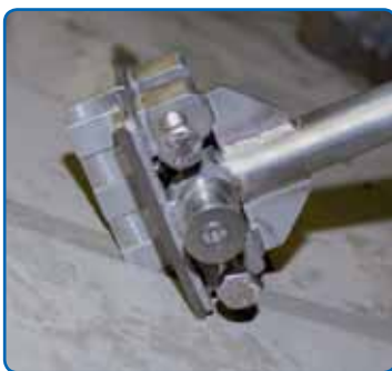
14-TK2 Detail Klemmechanismus
