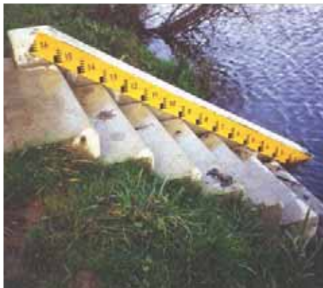
Treppen-Pegellatte an einem Seeufer, Ausführung Aluminium, einbrennlackiert.
